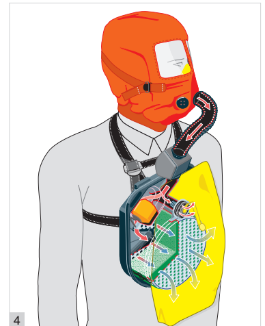
4 Exhalation cycle and purge of O 2 overproduction / Ausatmung mit Überschussabgabe
